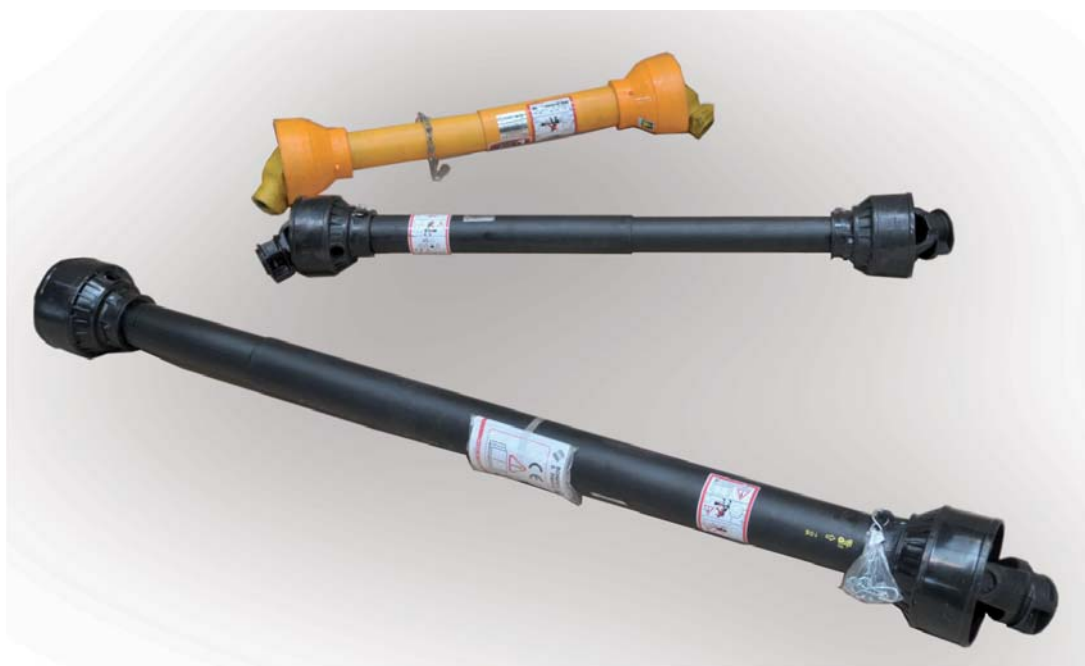
Каждый вал должен использоваться с неповрежденной крышкой, быть закрыт по всей длине и оснащен защитными цепями для предотвращения ее вращения. Пиктограммы, размещенные на вале, предупреждают о возможных опасностях
