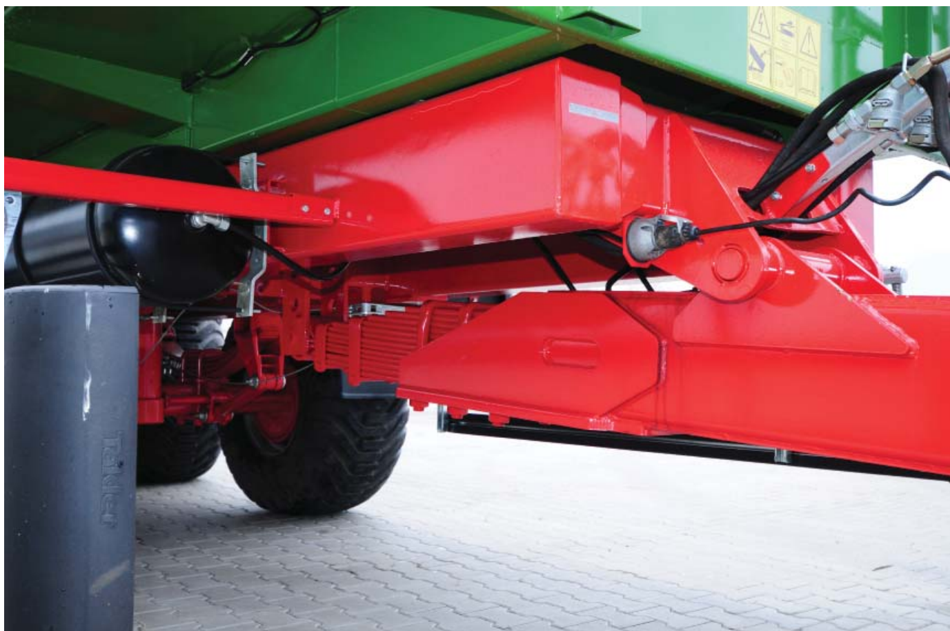
Дышло, выдерживающее нагрузку в три тонны, с возможностью регулировки высоты тяги
