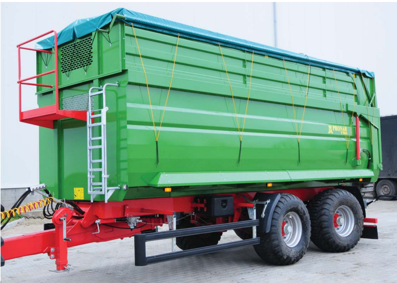
Складная лестница и балкон, облегчающие использование сворачиваемого тента
