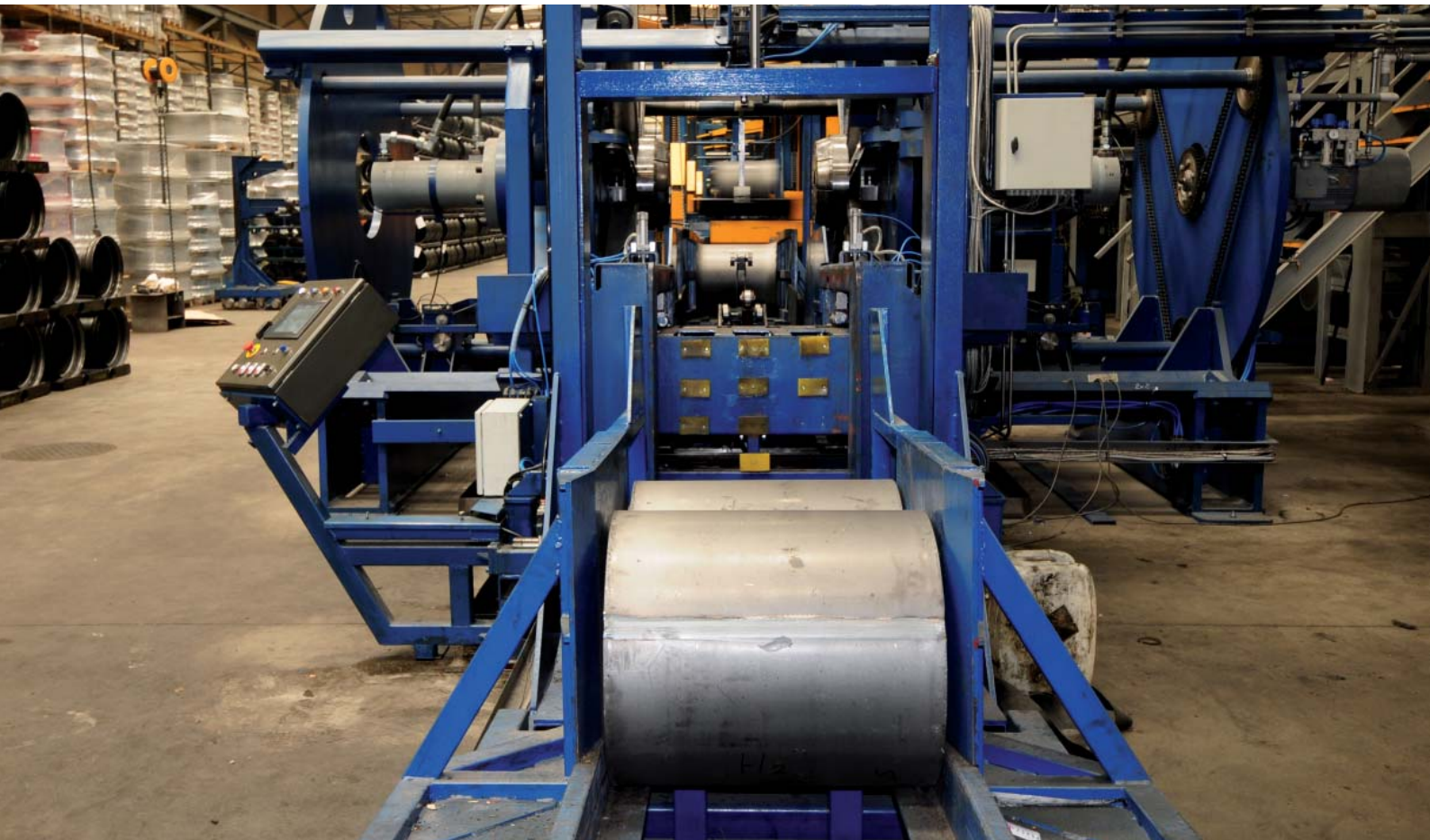
Предварительный расширитель в процессе производства ободов
