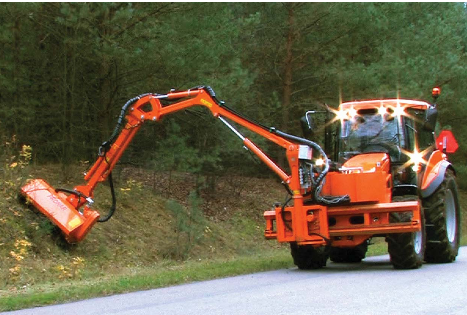
Дисковая косилка с системой задней и боковой навески PRONAR ВВК 200 во время работы
