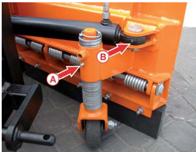
Точки смазки снегоотвала PRONAR PUV-1600: А - втулка вращения колесика, В - ухо поршня гидродвигателя, С - поворотная цапфа отвала
