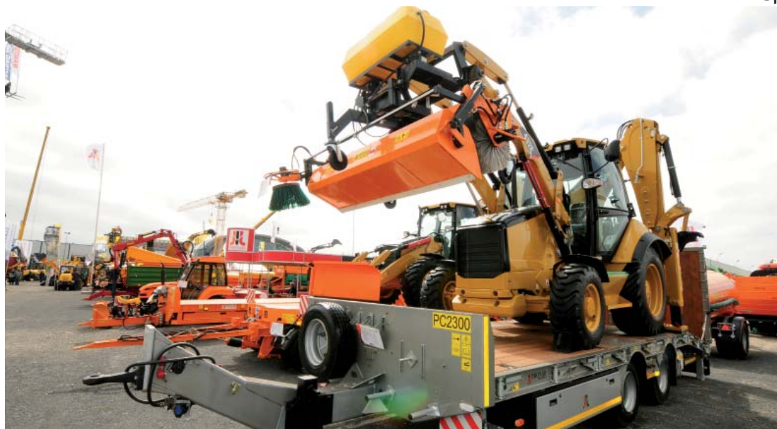
Система навески подметально-уборочной машины ZM 2000 позволяет агрегировать ее с экскаватором-погрузчиком CAT 432E
