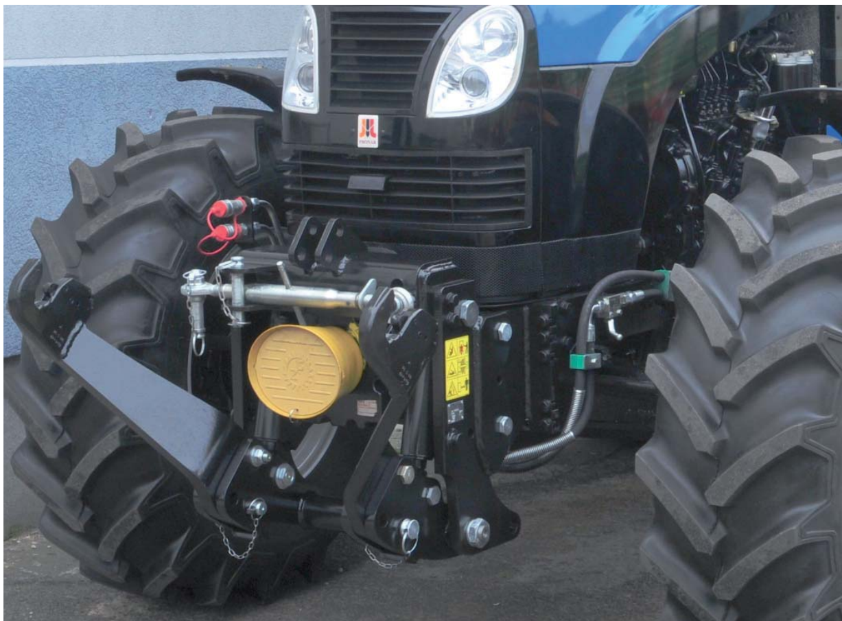
Защитная крышка подвижного элемента защищает от опасностей, связанных с вращающимися узлами машины
