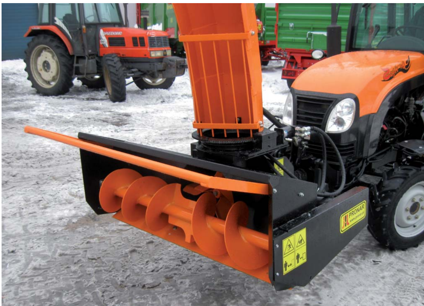
Сгребатель роторного снегоочистителя OW1.5 предназначен для измельчения и транспортировки снега внутрь машины. Следует позаботиться, чтобы он был очищен от остатков соледержащих материалов, ускоряющих коррозию металлических элементов.
