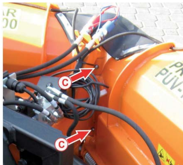
Точки смазки снегоотвала PRONAR PUV-1600: А - втулка вращения колесика, В - ухо поршня гидродвигателя, С - поворотная цапфа отвала
