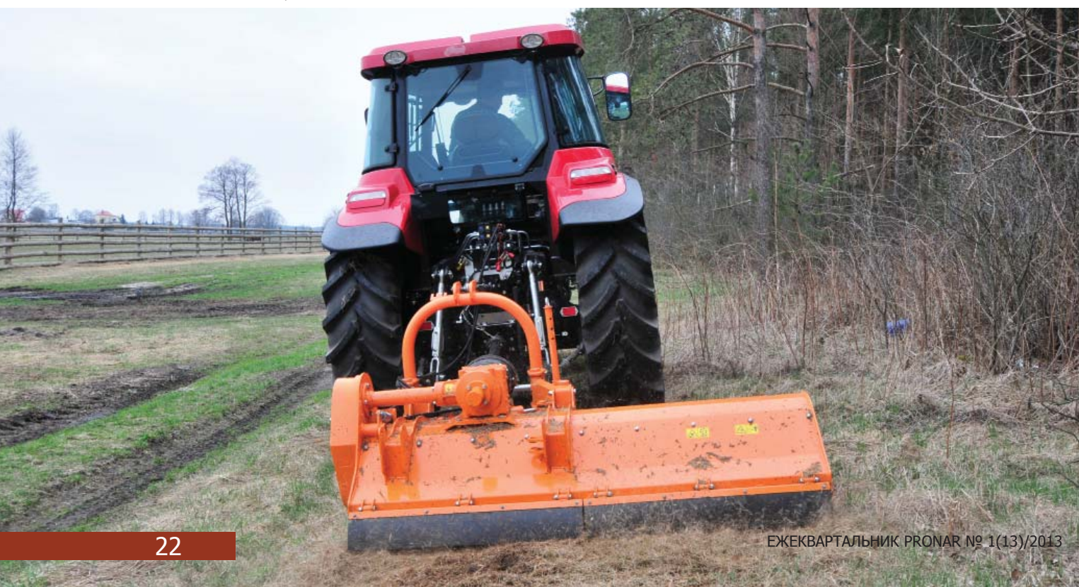
Косильная головка PRONAR GK 110 на гидравлической консоли
